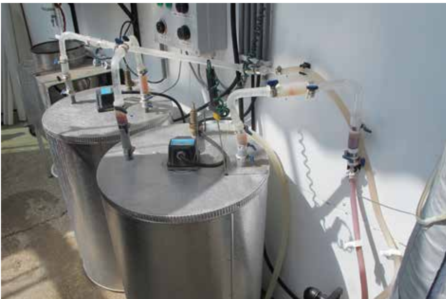
Pasteuriseerinstallatie voor zeewater
