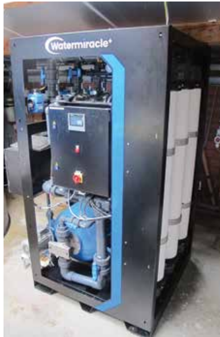
Ultrafilter voor uitstekende kwaliteit van zeewater
