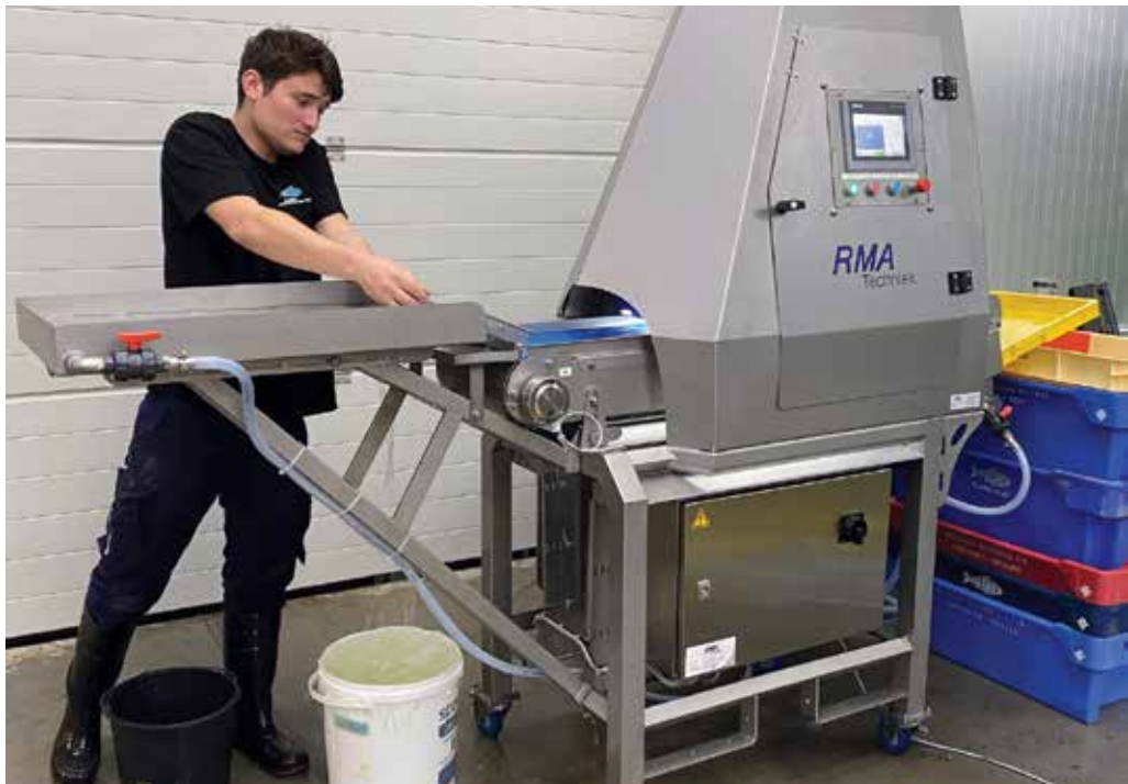
Sorteren met laser-camera
